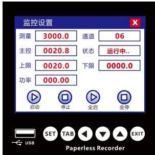
按下启动按钮，仪表启动控制功能，当前通道输出动作；按下停止按钮，仪表输出断开；按下全启按钮，仪表启动所有通道控制功能；按下全停按钮，仪表停止所有通道控制功能。
