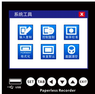
**输入复制:** 将第1通道的输入设置复制到其它通道；
