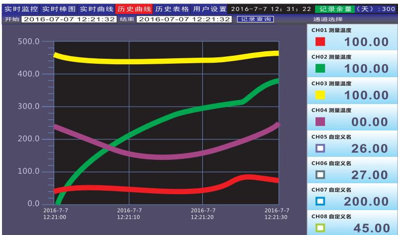
历史曲线与实时曲线基本相同，不同的时历史曲线与曲线间隔无关，直接输入开始时间与结束时间查询，无论是历史曲线还是实时曲线，坐标都是通过系统设置的坐标上限与坐标下限来实现的，注意，曲线在显示开关量时，将接通状态的值显示为100，断开状态的值定义为0,主要是为了开曲线时更直观，方便产生感观更强的方波曲线图，通道有开关量输入时,在设置曲线坐标时，应当使坐标上限设置大于100以上。
